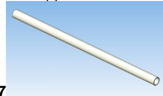
5R - Труба рефлектора основная – 2 шт. - труба алюминиевая диам.35 мм,L=1675.
