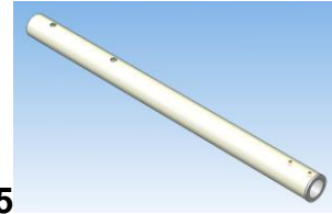
5R - Труба рефлектора основная – 2 шт. - труба алюминиевая диам.35 мм,L=1675.
